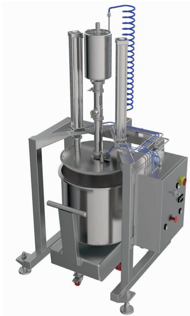
Carrello pneumatico con piatto raschiante per bacinelle con diametro fino a 700 mm.
